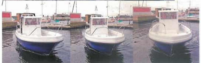
Wirkungsweise des Bugstrahlruders: Der Klein-Kutter lässt sich mit Joystick so einfach manövrieren wie ein Einkaufswagen
