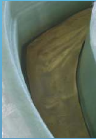
Holz im Süllrand zur Verstärkung einlamiert Wood coaming laminated in the cockpit as reinforcement
