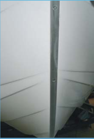
Edelstahl-Kielschutzleiste von außen durch geschraubt Stainless steel keel protection strip screwed from the outside
